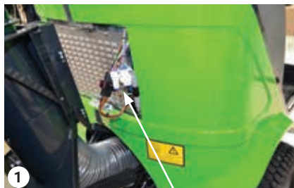
3 csatlakozó a rács mögött
