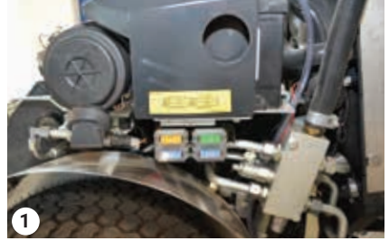
60 A JF15 generátor - 60 A JF1 tápegység biztosíték doboz 20 A JF2 vészhelyzeti kábel - 30 A JF3 motorteljesítmény
