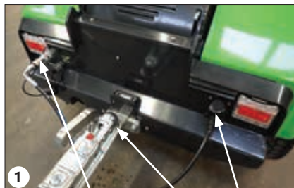
1 Hidraulikus csatlakozás Csatlakozó Csatlakozó aljzat
