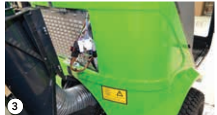
3 csatlakozó a rács mögött
